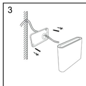
Colocar la base del aplique con los tornillos y hacer el conexionado eléctrico.
