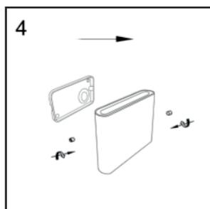
Colocar la tapa del aplique encima de la base y apretar los tornillos laterales de la base para su sujeción a la base.
