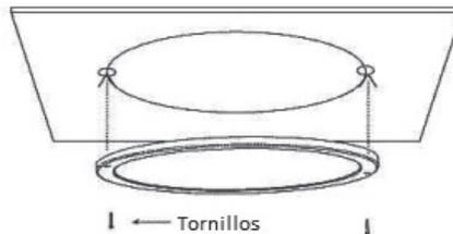
**Paso2.** Fije el panel LED con los tornillos en el techo.
