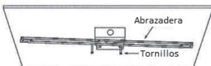
**Paso1.** Fije la abrazadera metálica en la caja de conexión con los tornillos.
