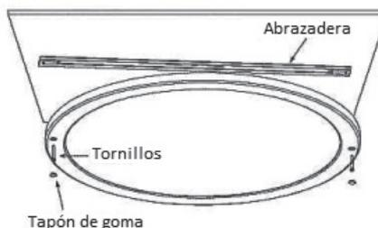
**Paso2.** Fije el panel LED en la abrazadera metálica con los tornillos y después ponga los tapones de goma en los agujeros del panel LED.
