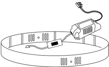
4. Conectar la clavija del transformador al del plafón.
