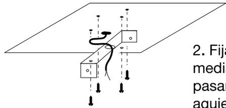
2. Fijar el anclaje en el techo o pared, mediante los cuatro tornillos adjuntos, pasando la toma de corriente a través del agujero del centro.
