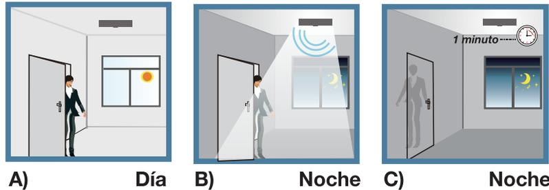
Este plafón tiene integrado un sensor de movimiento infrarrojo (PIR) y un sensor Crepuscular (sensor de luz: DIA/NOCHE).
