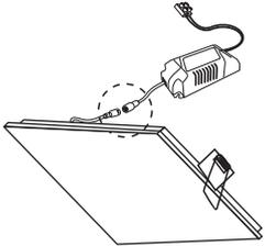
2. Conectar la clavija del transformador al del downlight.
