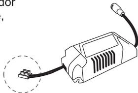
2. Conectar la clavija del transformador al del plafón.
