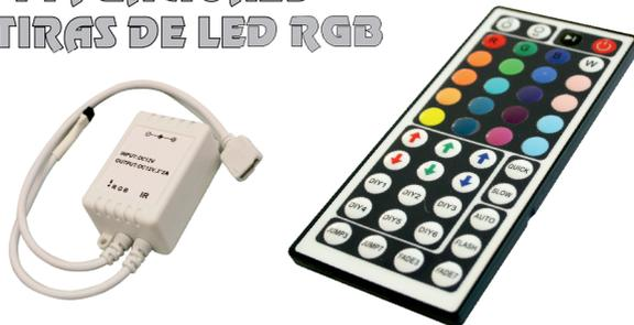
Controlador por infrarrojos de 44 funciones, de fácil utilización y conexionado, funciona a través de un microcontrolador, para el control de tiras de LED RGB. Dispone de ajuste de brillo, 20 colores diferentes y 8 efectos de luz diferente y personalización de 6 colores.
