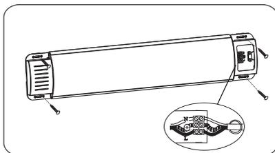
4. Colocar las tapas laterales con sus tornillos. Si es necesario o quiere separar la luminaria de la pared, puede usar los separadores que suministramos.
