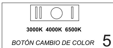
*Mediante el selector podrá seleccionar la tonalidad de luz deseada.*
