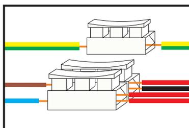
Conexionar la regleta, por la parte posterior, tal y como se indica en la imagen.
