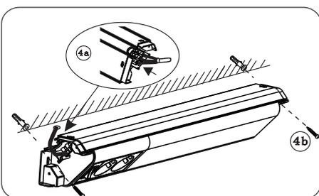
4. Atornillar las tapas laterales y fijar en la pared.
