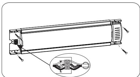
Conexión la regleta tal y como indica en la base L,  $\oplus$ , N, pasando el cable a través del agujero de la base.
