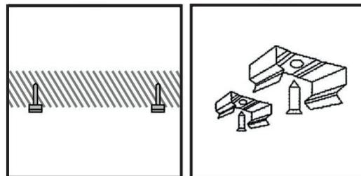
Realizar los agujeros en la pared y colocar los tacos. A continuación pasar los tornillos a través de las abrazaderas metálicas y fijarlos.
