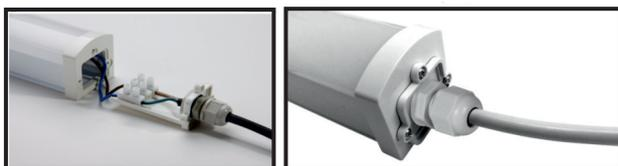
Conexión de la regleta tal y como indica en la base L, N, pasando el cable a través del agujero del prensaestopa. Posibilidad de conexión de varias pantallas en paralelo.
