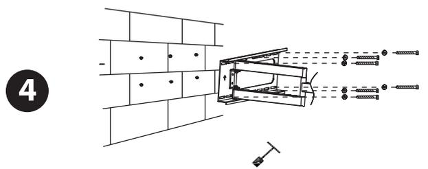
Fijar el soporte a la pared utilizando los 6 tornillos (A) .
