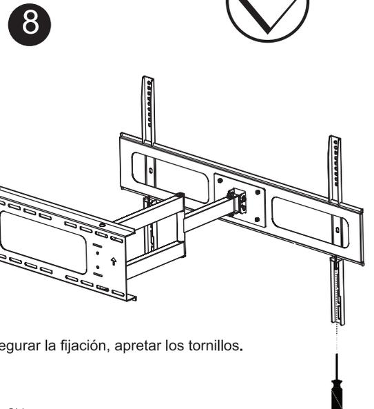
Para asegurar la fijación, apretar los tornillos.
