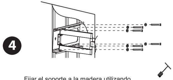
Fijar el soporte a la madera utilizando los 6 tornillos (A) . .
