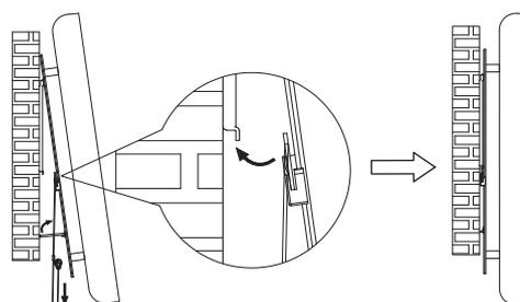
Después de la conexión de los cables estirar de la cuerda para fijar los anclajes de la parte trasera de la TV.
