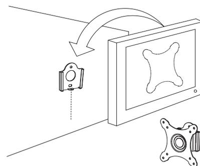
A Utilizar tornillo (C) para fijar las dos platinas y asegurar y fijar el TV.
