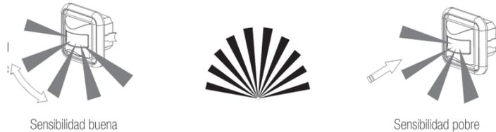
Evitar colocar el detector frente a fuentes de calor o reflectantes u objetos móviles que pueden dar falsas detecciones.
