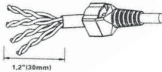
3- Despliegue los cuatro pares trenzados. Siguiendo la tabla de codificación de colores. Asigne cada conductor a las ranuras adecuadas del módulo guía.
