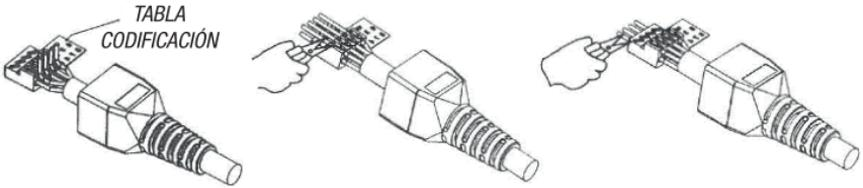
4- Coloque el módulo guía en el conector.
