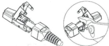
6- Cierre la cubierta del conector. Asegúrese de que el cable trenzado esté en contacto con el clip del conector. Pase la brida por el agujero y que se fije al clip del conector.
