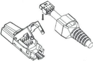
5- Ajustar la tapa del conector utilizando un alicate para sujetar el cable hasta que encaje por completo.
