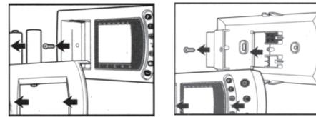
2) Saque el tornillo situado en la cubierta trasera que protege la regleta de conexión.
