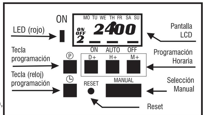
El LED rojo, nos indicará que está en funcionamiento el temporizador, debido a que un programa está actuando, o lo hayamos encendido manualmente.
