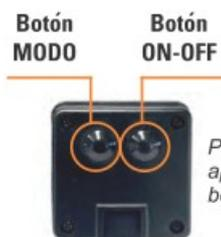
Placa solar con botón de apagado y encendido y botón selector de efectos
